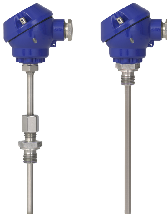
Рис. слева: Модель TC10-D с технологическим присоединением с компрессионным фитингом Рис. справа: Модель TC10-D с технологическим присоединением с шестигранной втулкой с двухзаходной резьбой
