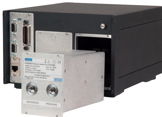
Съемный / сменный эталонный чувствительный элемент
