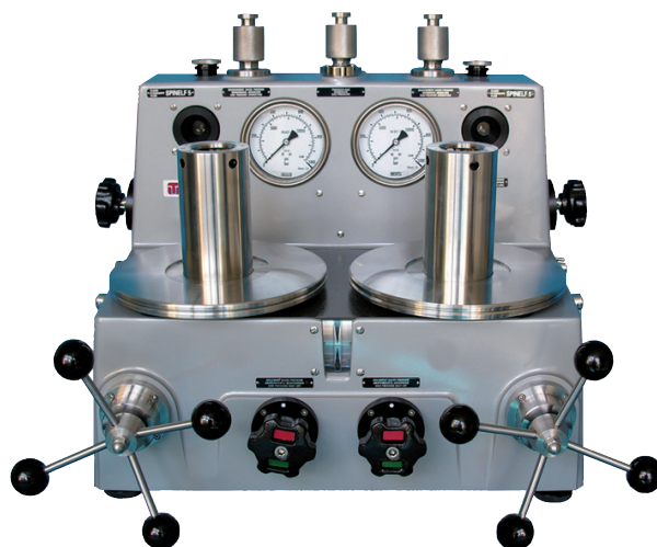
Эталонный грузопоршневой манометр дифференциального давления, модель CPB6000DP
